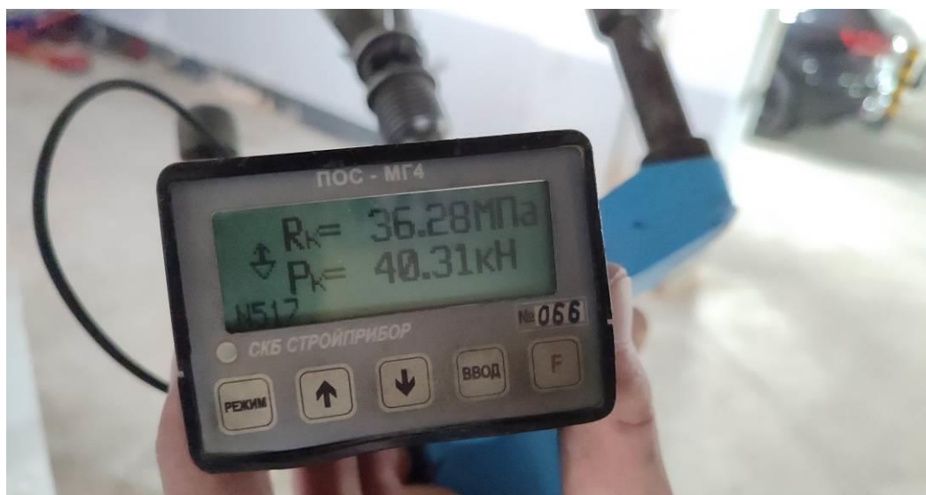
Фото 3, 4. Фотофиксация испытания прочности бетона методом отрыва со скалыванием
