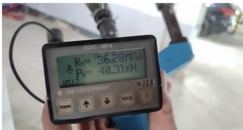
Фото 3, 4. Фотофиксация испытания прочности бетона методом отрыва со скалыванием
